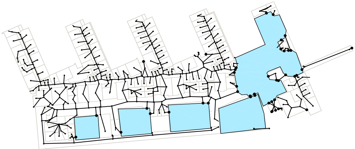
Kuva 3.1: Automaattisesti luotu karttarakenne testirakennuksesta. Rakennuksen ulkoseinät on kuvattu harmaalla värillä ja linkit sekä solmupisteet on kuvattu mustalla värillä. Avoimet alueet, jotka on kuvattu sinisellä värillä, ja graafin yhdistävät solmupisteet on merkitty kuvaan muita solmupisteitä suuremmilla pisteillä. Rakennuksen ulkokuolinainen alue tulkitaan myös avoimeksi alueeksi.
