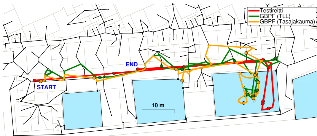
Kuva 6.10: GBPF-suodattimien paikkaestimaatit ensimmäisellä testireitillä, kun mittausten väli on kymmenen sekuntia. Testireitin ja suodattimien paikannustuloksia on havainnollistettu ympyröillä tasaisin väliajoin.
