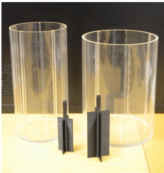
Kuva 4.4. Lapasysteemit ja säiliöt. Vasemmalla pieni säiliö (1,4 l) ja pieni lapasysteemi. Oikealla iso säiliö (2,2 l) ja iso lapasysteemi.
