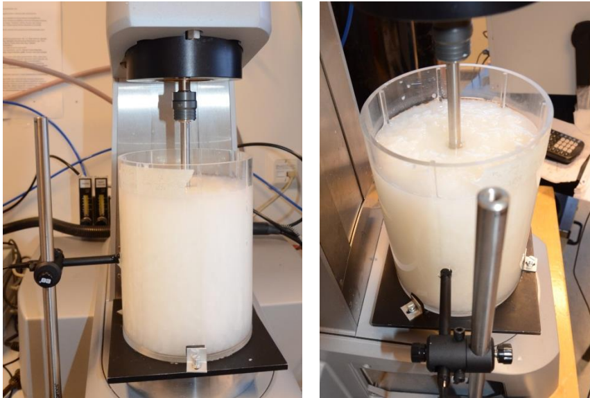
Kuva 4.8. PUDV-laitteiston mittausjärjestely. Vasemmalla mittalaitteisto sivulta ja oikealla takaa, mistä näkyy kuinka anturi on pienessä kulmassa säiliön säteeseen nähden.
