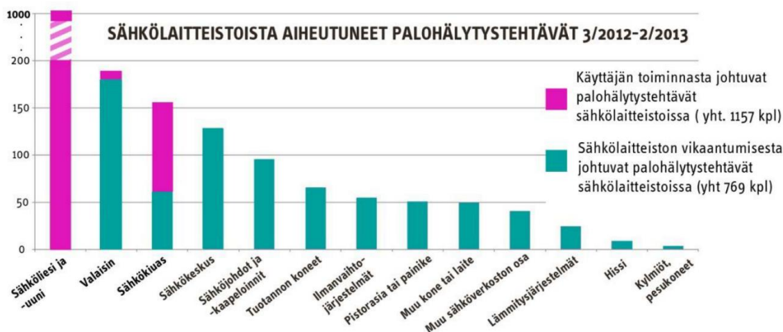
Kuva 1. Sähkölaitteistoista aiheutuneiden palojen jaottelu käyttäjän toiminnasta ja laitteiston vikaantumisesta aiheutuneisiin hälytystehtäviin (Hatakka, Valkeinen & Huurinainen 2014).
