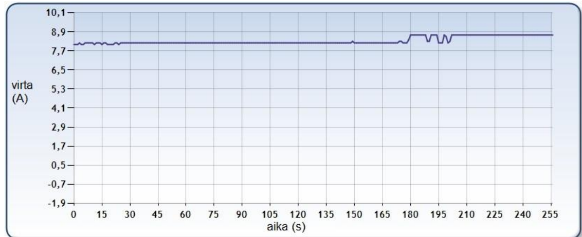
Kuva 65. Rinnakkaisvian ja maaoskosalun ilmenemismuoto virtamittauksessa..
