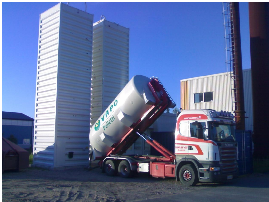
Kuva 8: Pellettien purku siiloihin (Korsu Oy).
