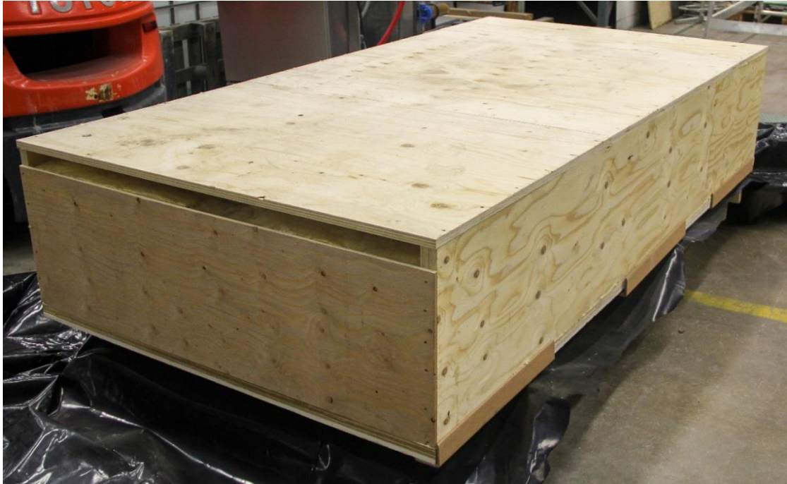
Kuva 4.10. Valokuva tutkittavasta elementtitehtaalla valmistetusta matalammasta koe-elementistä. Elementin eristepaksuus on 400 mm.
