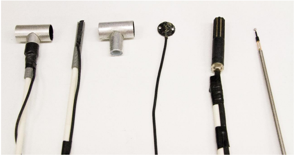
Kuva 3.13. Esimerkit laitteistossa käytetyistä antureista. Vasemmalta oikealle lueteltuna: Ilmalämpötila-anturi säteilysuojuksen kanssa, kiinnitystikussa oleva ilmalämpötila-anturi, jonka päältä säteilysuojus on nostettu pois, pintalämpötila-anturi, kosteusanturi kiinnitystikussa ja ilmavirtausanturi (kuumalanka-anemometri).
