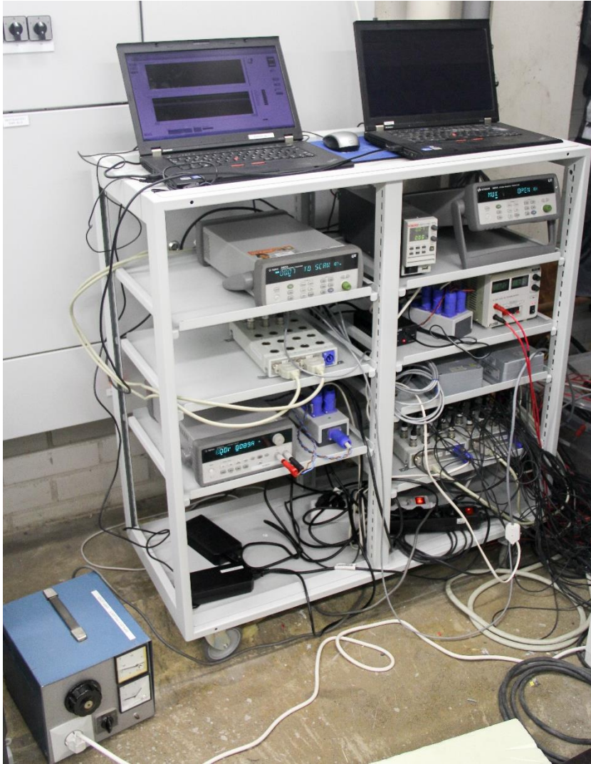
Kuva 3.14. Laitteiston mittausasema pakkashuoneen ulkopuolella.
