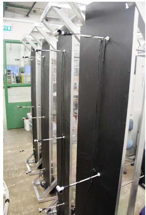
Kuva 5. Kylmän kammion suojakammion ja suojalevyjen osia ennen laitteistoon asentamista.
