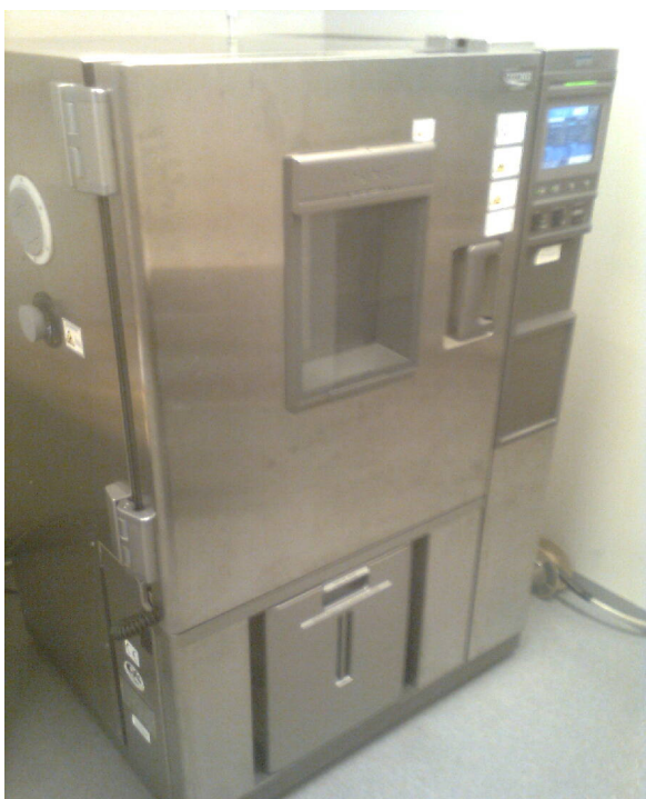
Kuva 16. Ikäännyttämisessä käytetty testikaappi Espec PL-1K.
