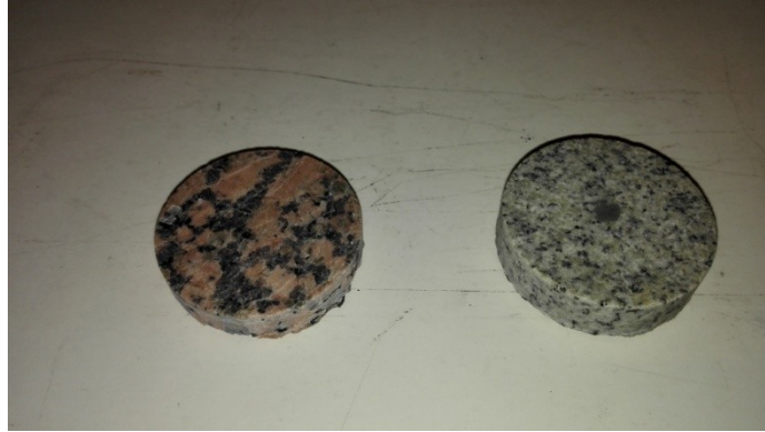
Kuva 3: Poratut kiviäytteet: vasemmalla Taivassalon punainen graniitti ja oikealla Kurun harmaa graniitti
