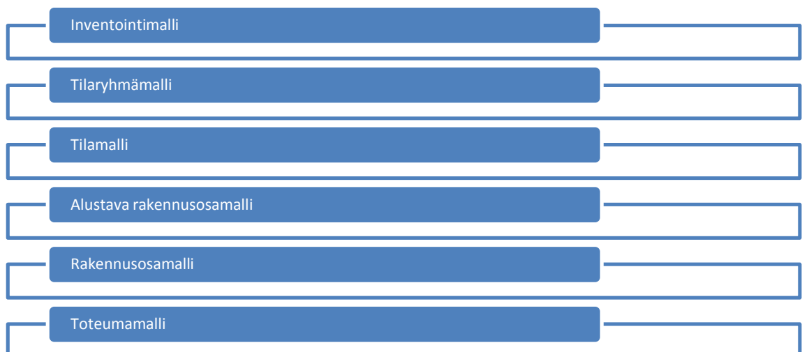
Kuva 10. Tietomallivaiheet tietomallivaatimusten mukaan (BuildingSMART Finland 2012, osa 1)
