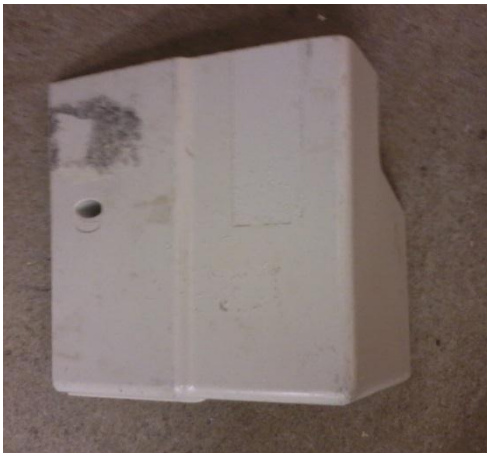
Kuva 13. Pesty PC/ABS-kotelo, jossa näkyy edelleen liimajälkiä
