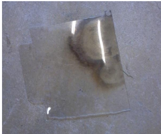
Kuva 15. Esimerkki pesusta puhdistumattomasta PC-levystä
