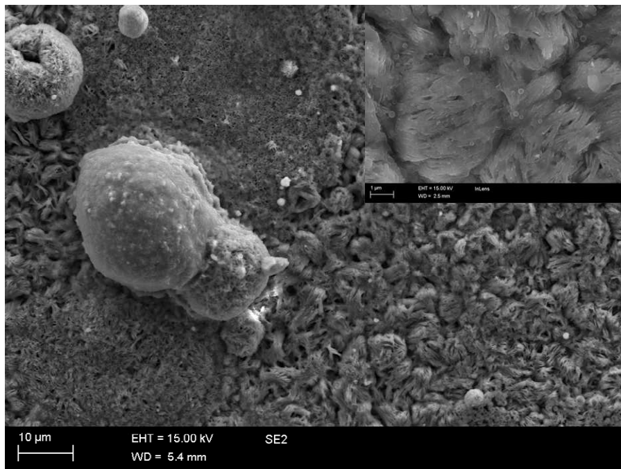
Kuva 27. Suuremmalla suurennoksella otettu SEM-kuva puhdistamattomalle mikroskooppilasille tehdystä sinkkioksidipinnasta. Oikeassa alakulmassa yksityiskohta samalta alueelta.
