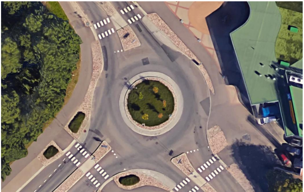
Kuva 37. Louhelantien ja Uomatien kiertoliittymä Vantaalla, jossa poistumissuunta on kavennettu yliajettavilla korokkeilla. (Google Maps 2017)
