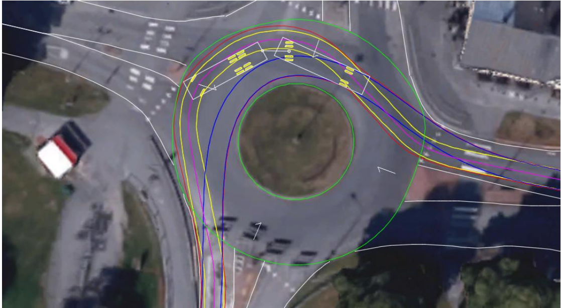
Kuva 25. Moduulirekan ajouramallinnus TORUS-ohjelmalla Porin sillan kiertoliittymässä. (Taustakartta Google Maps 2017)
