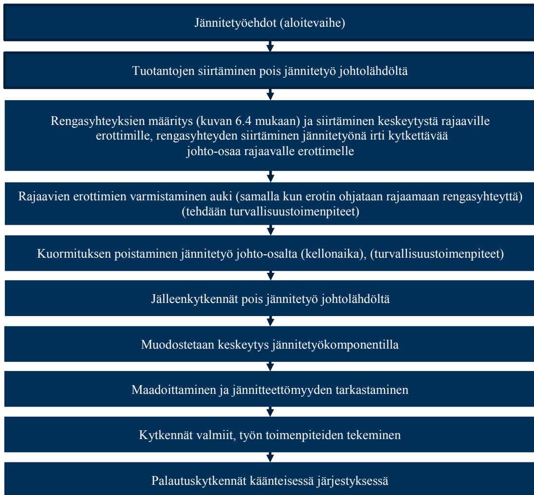
Kuva 6.6 Kytkentäohjelman muodostaminen jännitetyöhön, jossa otetaan verkkoa jännitteettömäksi.
