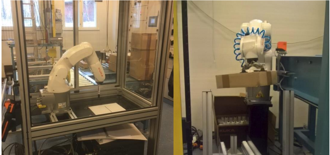
Kuva 19. Liikuteltava robotti vasemmalla ja kiinteästi asennettu robotti oikealla
