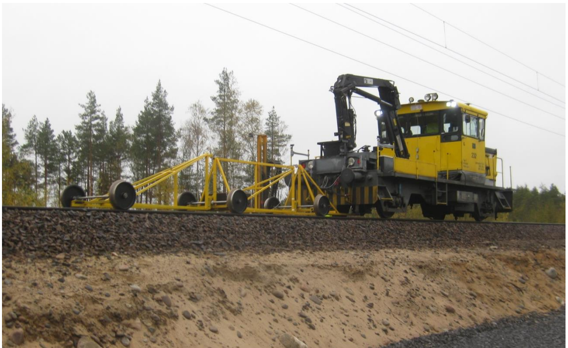
Kuva 63. Tampereen teknillisen yliopiston palautuvan painuman jatkuvatoiminen mittalaitteisto.
