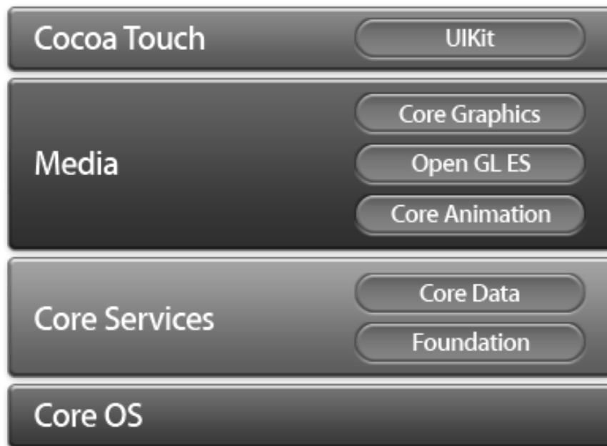
Kuva 9: iOS:n kerrokset ja joitakin tärkeimpiä ohjelmistokehyksiä. [11]
