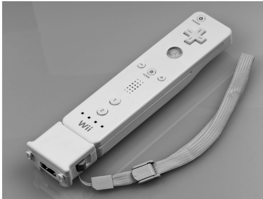
Kuva 7: Wii Remote ohjaimessa on kolmiulotteinen kiihtyvyyssanturi. Kuvassa ohjaimen alaosaan on kiinnitetty MotionPlus -laajennus, joka lisää ohjaimen kolmiulotteisen gyron.
