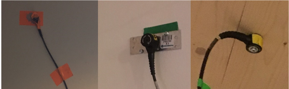
Kuva 11. Esimerkkikuvia anturin kiinnitystavoista vasemmalta oikealle: kemiallisella metallilla suojateipin päälle, magneetilla seinään ruuvattuun naulauslevyyn ja ruuvilla puuhun.
