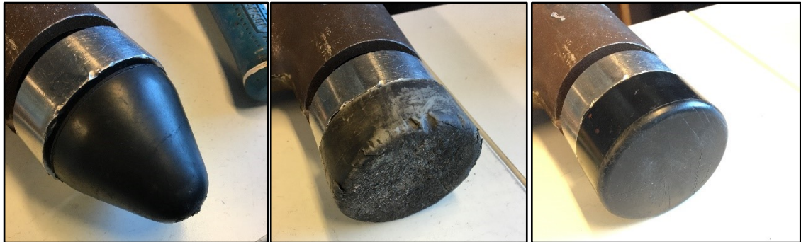
Kuva 12. Iskuvasaran kärkiä vasemmalta oikealle: pehmeä kumi, kovempi kumi ja kova muovi.
