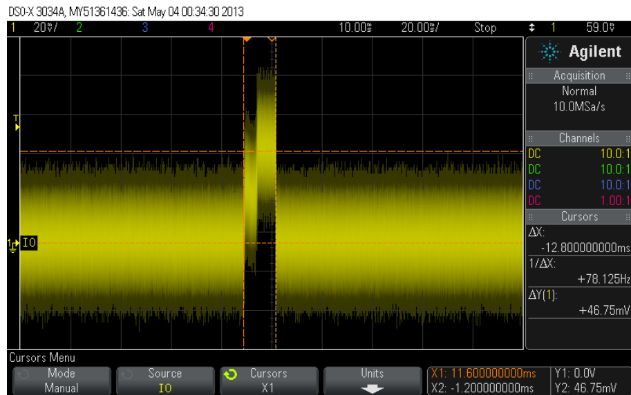
Kuva 6.1: Näppäimistömoduulin jännitehäviö 1\Omega virranmittausvastuksen yli.
