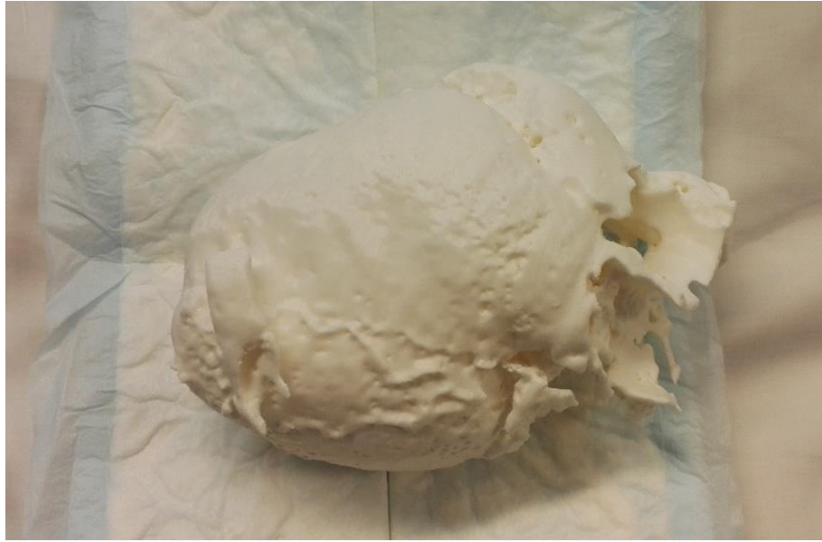
Kuva 1. 3D-tulostettu sydänmalli, jota voidaan käyttää anatomisena fantomina ultraäänikuvauksessa.
