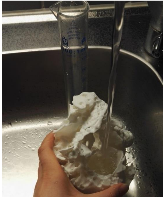
Kuva 23. Fantomi täytettiin vedellä sen vasemman kammion tilavuuden selvittämiseksi.
