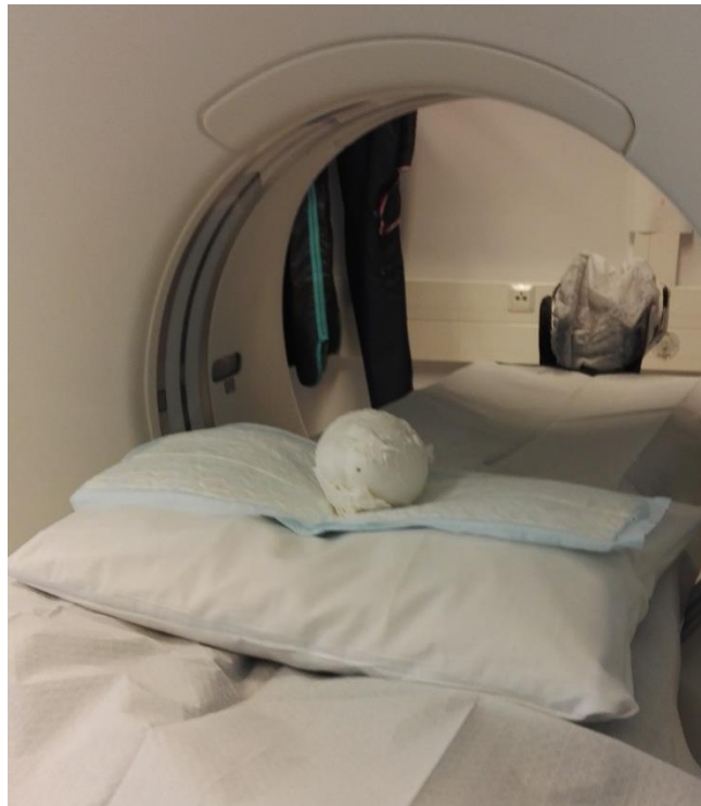
Kuva 22. Fantomin asettelu TT-laitteeseen. Kappale oli tyynyn päällä, jotta se saatiin sopimaan paremmin kuvausalueeseen.
