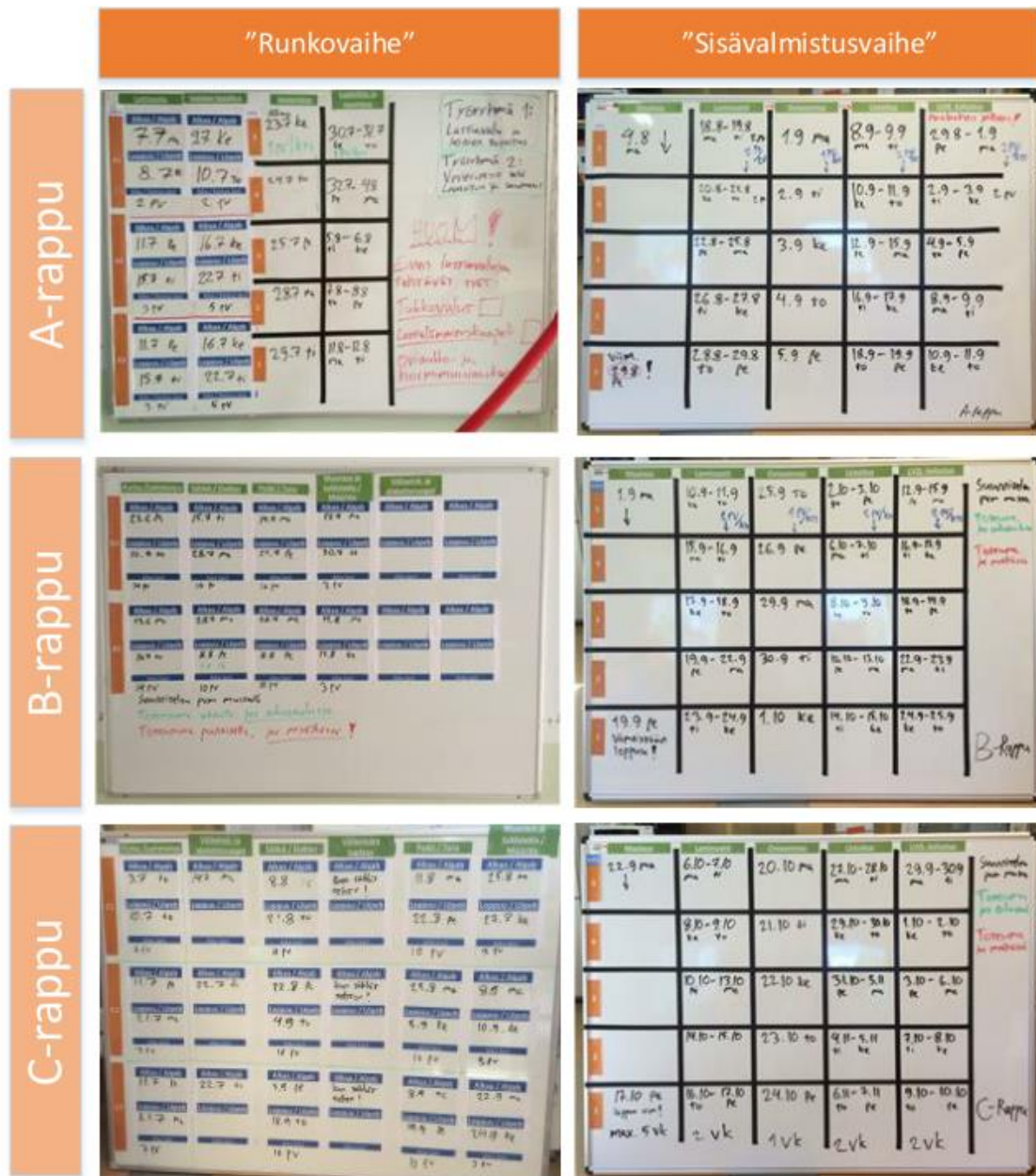
Kuva 11. Myyrinkulman runkovaiheen ja sisävalmistusvaiheen porraskinjetit (Alastalo 2014, s.117)
