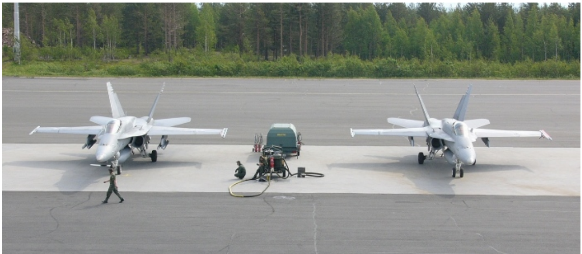
Kuva 2.1. Hornet-hävittäjiä konepaikoilla, joilla tankkaus voidaan tehdä kiinteästä hydrant-järjestelmästä.
