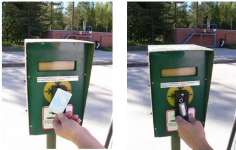
Kuva 5.2. Luottokortin mallinen henkilö tunniste ja avaimenperätyyppinen ajoneuvotunniste esitetään lukijalle ennen APAJA-tankkausta.
