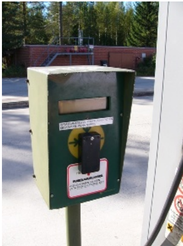
Kuva 5.1. Jakeluasemilla on Idesco IR 8090 B -malliset RFID-lukijat tankkaajien ja ajoneuvojen tunnistamista varten.
