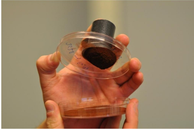
Kuva 4.16: Rautanitraatti 1:4:stä valmistettua jauhetta nostetaan magneetilla.
