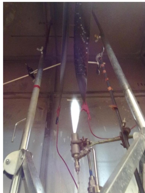
Kuva 3.3: Vasemmalla on sähkösuodattimen periaatekuva. Oikealla on alaviistosta otettu valokuva suodattimesta, kun se on asennettuna vetokaappiin ja nesteliekkiruisku on käytössä.
