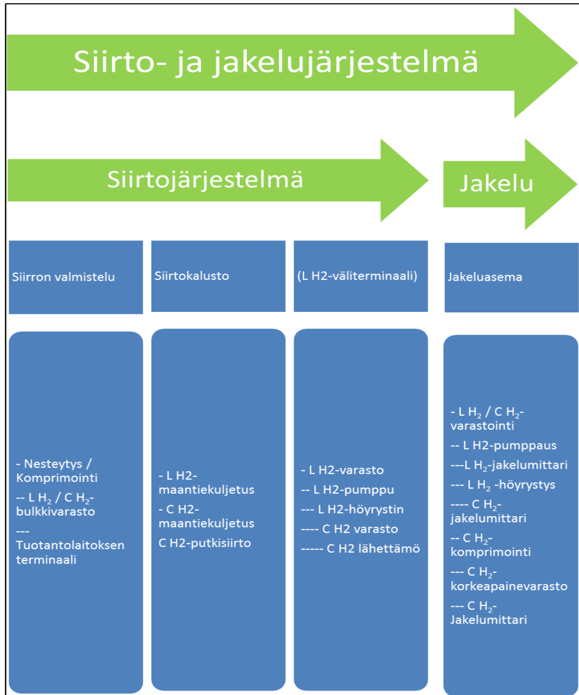
Kuva 5.4 Vedyn siirto- ja jakelujärjestelmän kaavioesitys. L H 2 : nesteytetty vety, C H 2 komprimoitu vety. (mukaiillen Nexant, 2008b)
