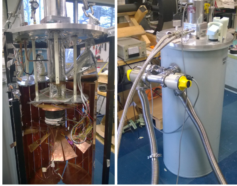
Kuva 4.8 Kryostaatti ilman ulkokuorta ja sen kanssa.
