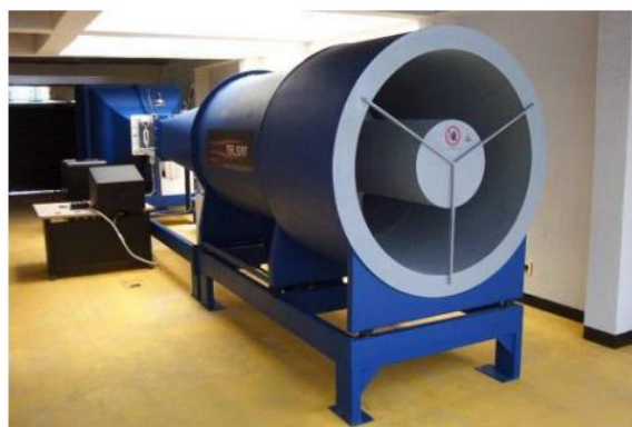
Figura 9 Túnel de Viento modelo M01-125-140M (Correa, 2010)
