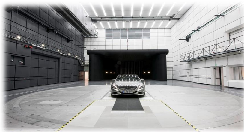
Figura 5 Sección de prueba del túnel de viento (Mercedes-Benz, 2016).
