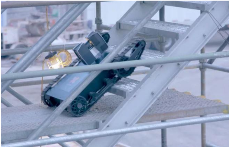
Kuva 22. Rakennustyömaalle soveltuva kuvausrobotti (Doxel 2018)
