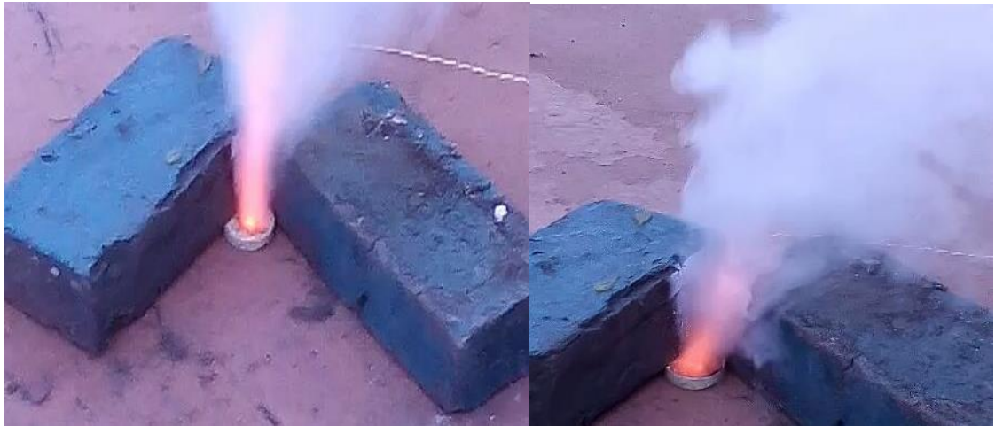
Figura 38 Quema de propelente utilizando el circuito eléctrico.
