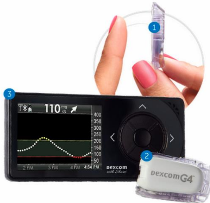
Kuva 5. Dexcomin jatkuvatoiminen glukoosianturi. 1) Neulamainen anturirakenne 2) lähetinyksikkö 3) kannettava monitori [28]
