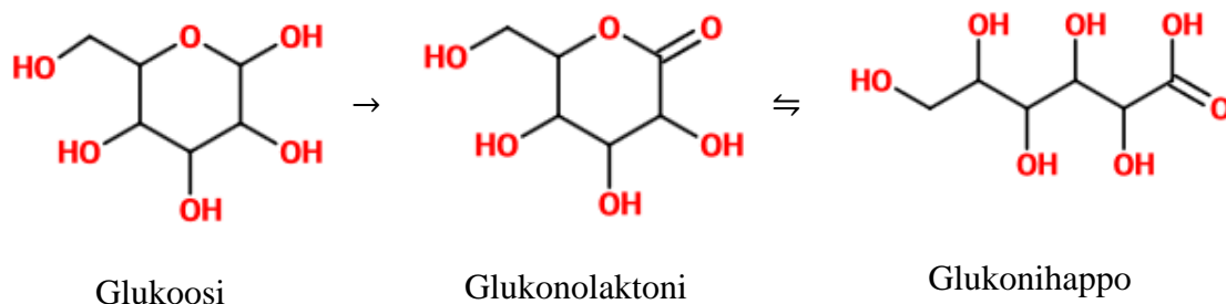
Kuva 7. Hapetusreaktiossa osallisena olevat molekyylit. Happea, vetyä ja siirtyviä elektroneita ei ole esitetty kuvassa. © Anna Hakala
