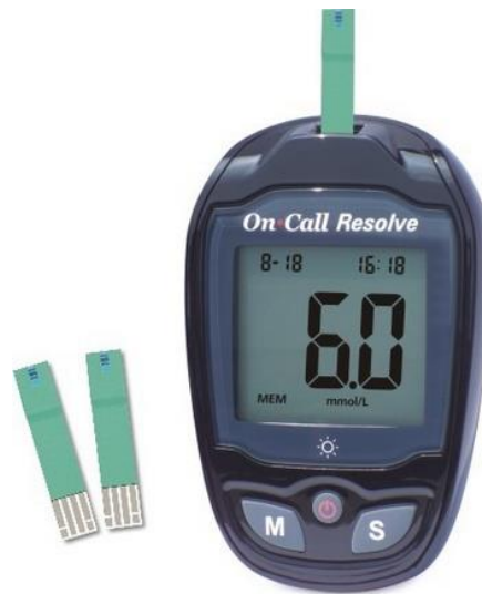
Kuva 3. Nykyaikainen entsyymaattinen verensokerimittari ja näyteliuskat [20]
