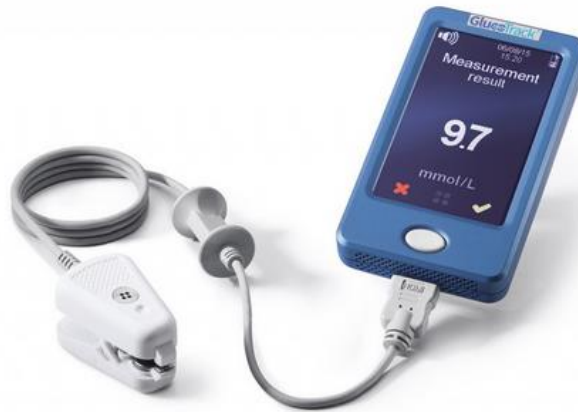
Kuva 4. GlucoTrack-mittauslaite verensokerin kajoamattomaan mittaamiseen. [27]
