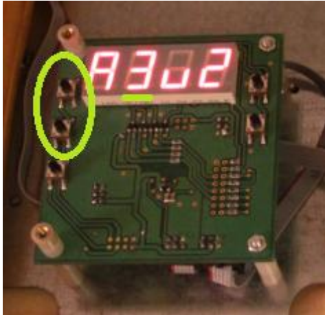
Kuva 46. Asetusarvonapit sekä asetusarvo 3.
