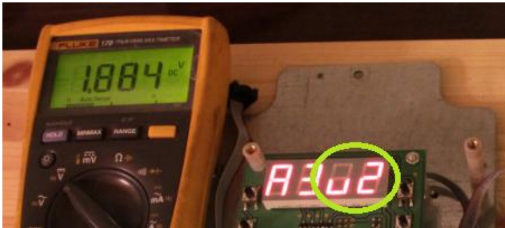
Kuva 45. Näytön toiminta: u2:sta vastaa sisääntulon jännitealue 1,00-2,00V.
