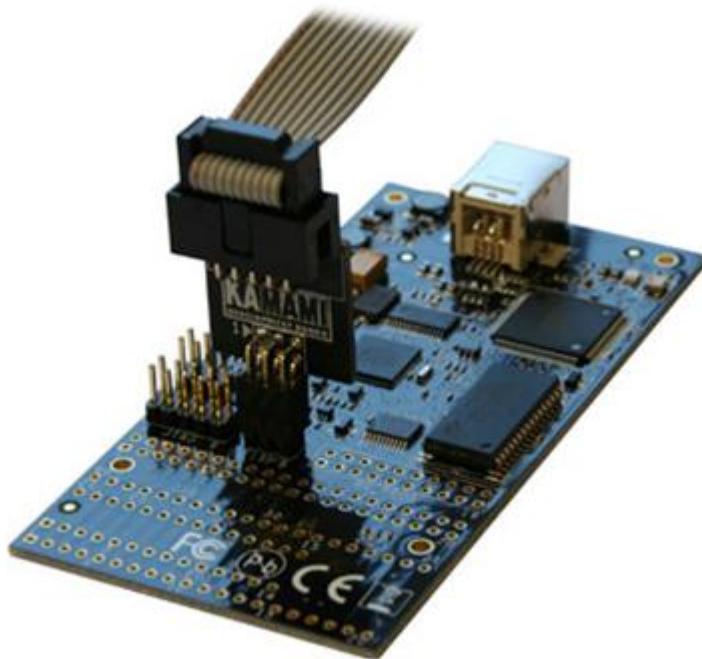
Kuva 36. AVR Dragon Debugger ohjelmointityökalu.
