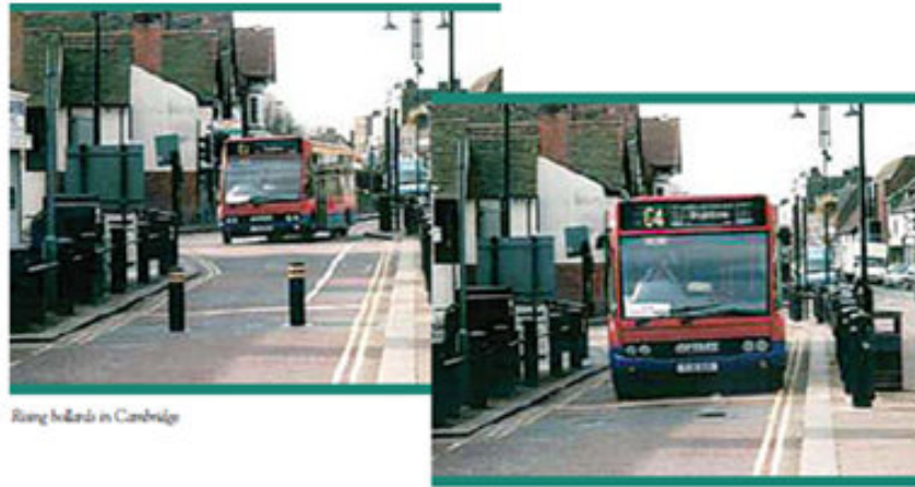
Kuva 120. Bussin saapuessa liukupollarit laskeutuvat maahan. Esteet on toteutettu joukkoliikennekadulla Cambridgessa ja Hillsboroughin alueella Sheffieldissä (Dft 2003; Citytransportinfo 2010).
