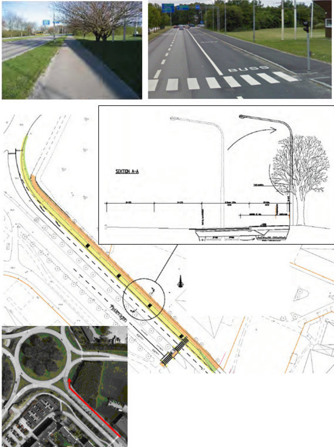
Kuva 67. Bussikaistan toteutus Fjellievägenillä: yläoikea kuva: tilanne ennen, ylävasen kuva: tilanne rakentamisen jälkeen, alavasen kuva: kokonaisuus ympäristössä (Lunds kommun 2010).
