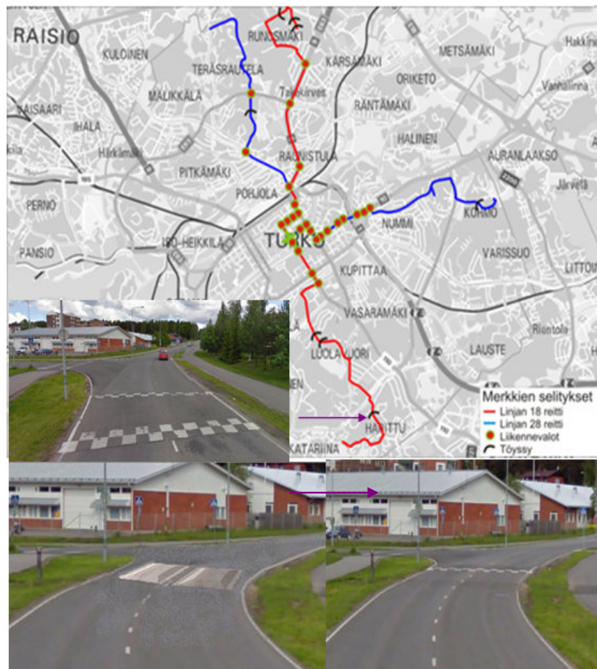
Kuva 147. Linjojen 18 ja 28 hidasteet ja liikennevalot sekä esimerkkiliittymä Haritusta (Turun kaupungin JLT 2010, havainnekuva Nieminen P).
