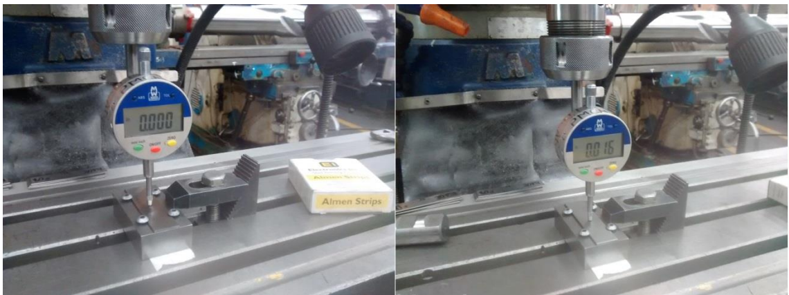
Figura 41. Medición de altura en tiras de prueba Almen. Fuente: El autor
