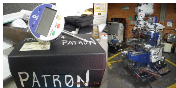
Figura 39. Fresadora NC y comparador de caratulas utilizados para medición de intensidad Almen. Fuente: El autor
