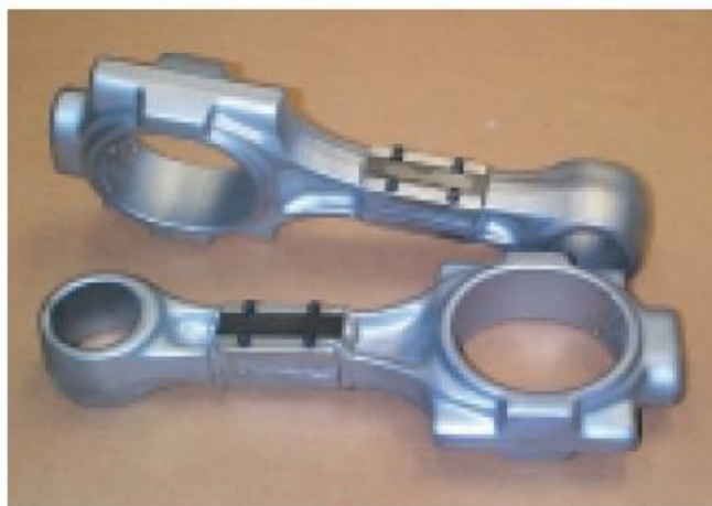
Figura 18. Configuración de accesorio de sujeción con tira de prueba Almen en pieza a tratar con proceso de Shot Peening.
