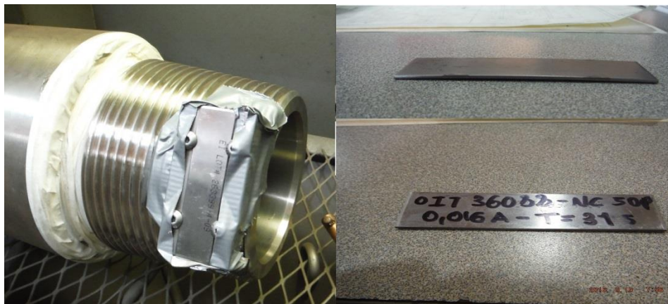
Figura 44. Prueba de intensidad Almen en NC50 API PIN. Fuente: El autor.
