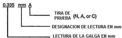
Figura 15. Designación estándar de la medición de la intensidad Almen (unidades en mm). Fuente: SAE J442, 2001. (Modificada).
