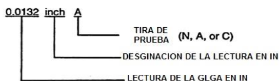
Figura 16. Designación alternativa para la medición de la intensidad Almen (unidades en in) Fuente: SAE J442, 2001. (Modificada).
