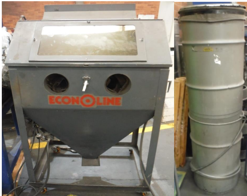
Figura 36. Cabina de granallado ECONOLINE. Fuente: El autor.
