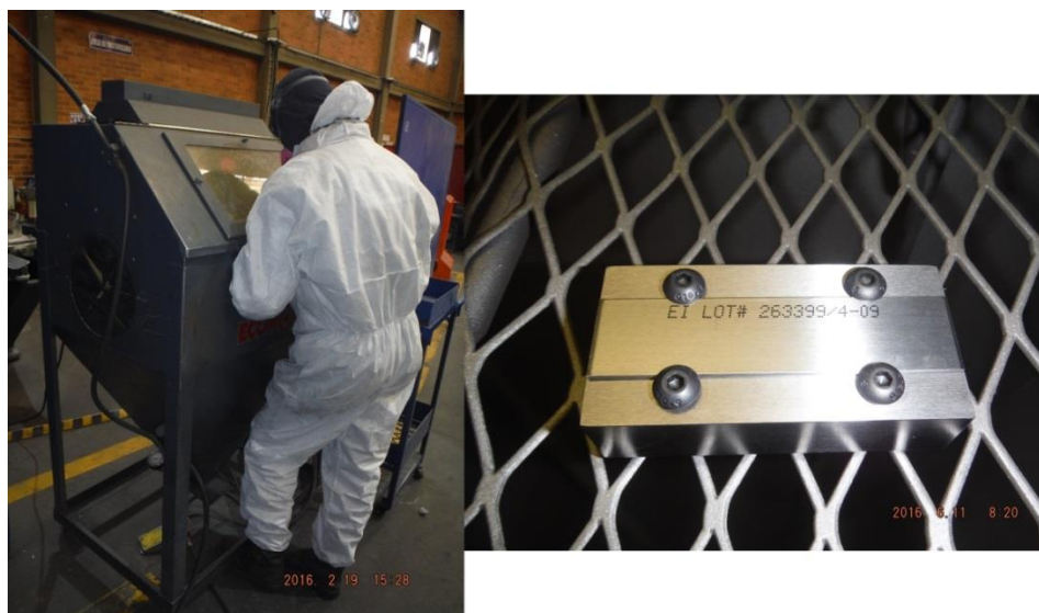
Figura 40. Realización de Shot Peening sobre tiras de prueba Almen. Fuente: El autor
