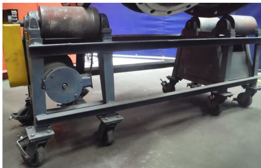
Figura 37. Sistema de rodillos giratorios. Fuente: El autor
