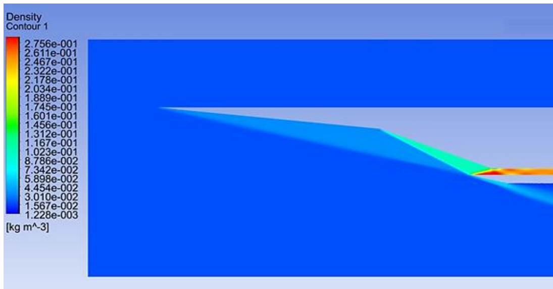
Figura N 19. Contornos de colores de Densidad en la sección de compresión, autores.
