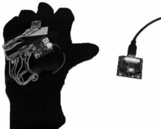
Figura 1 Prototipo guante de datos y terminal de recepción Fuente: [14]
