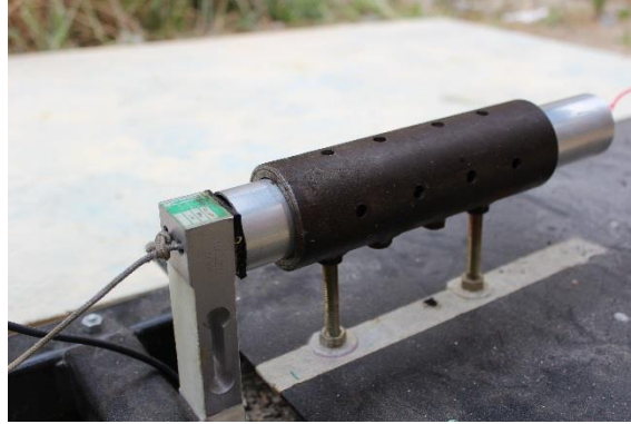
Figura 18. Motor instalado y listo para pruebas
