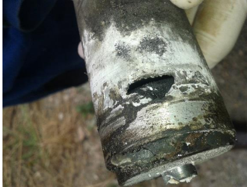
Figura 45. Falla del motor (Orificio de salida de gases).
