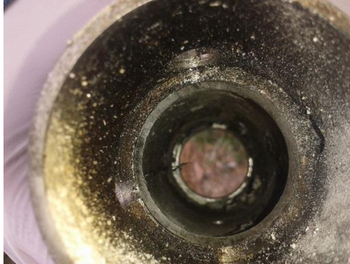
Figura 46. Residuos de combustión en la base del motor (Banco de Pruebas).
