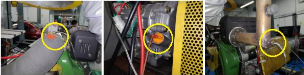
Figura 7. Posición de las termocuplas
