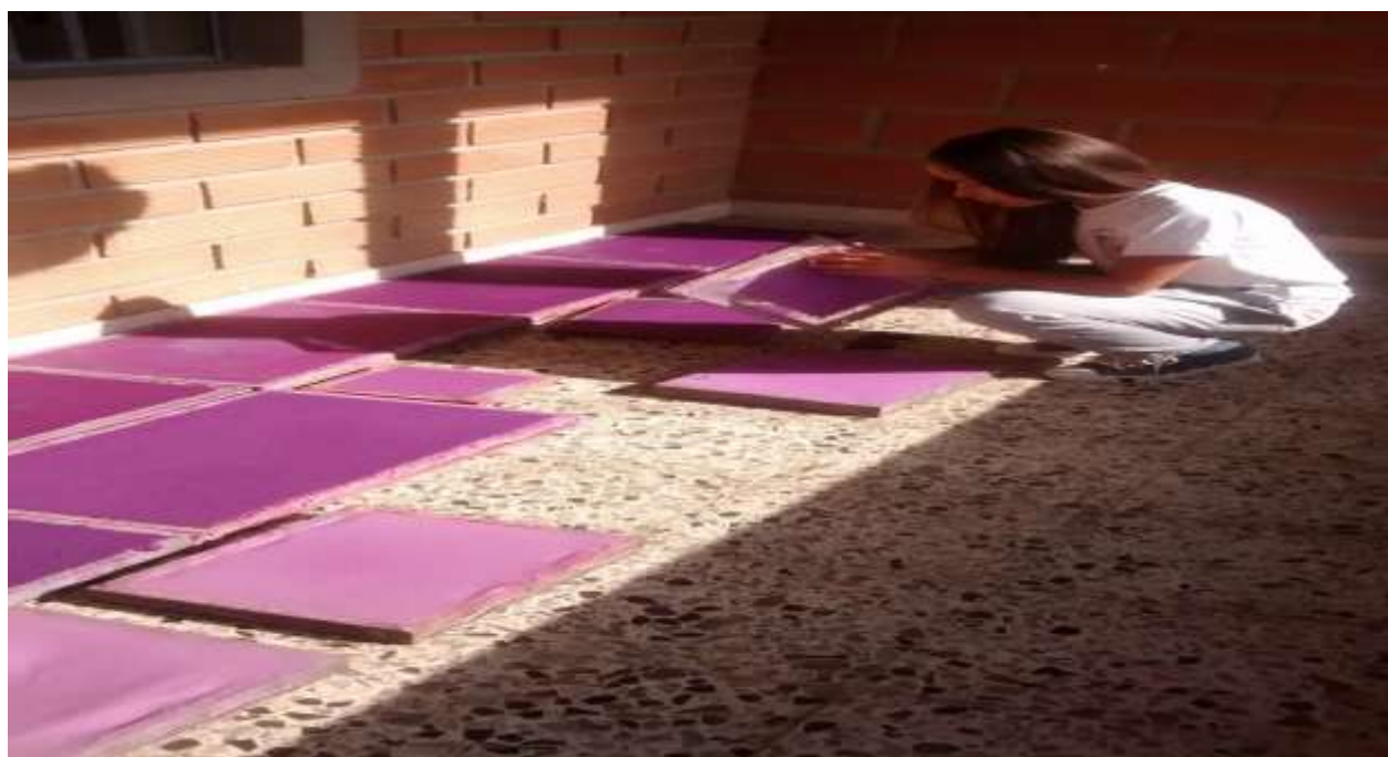
Fotografía 5: Separación de las hojas de papel de los moldes
