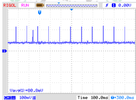
Figura 31 Valor medio de corriente que consume el NodeMCU en modo activo
