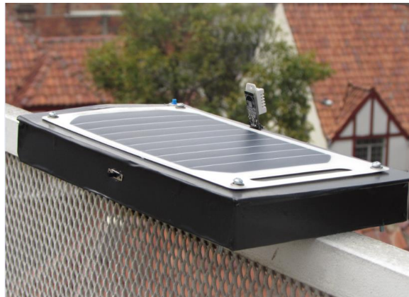
Figura 45 Prototipo de nodo WSN alimentado con un sistema de recolección de energía. Fuente: Autor
