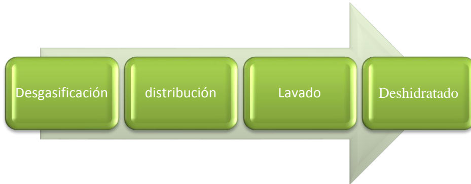
Ilustración 7 Proceso de deshidratación en un Gun Barrel
