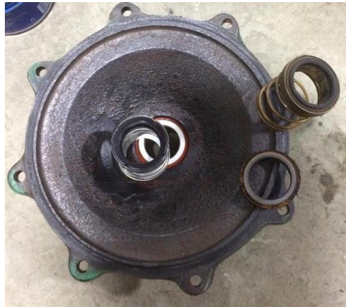
Figura 13. Cambio de sello mecánico. ((Propiedad de los autores Ingecol S.A.S), 2018)
