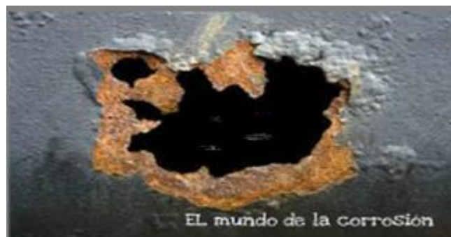
Ilustración 12. Corrosión por exfoliación
