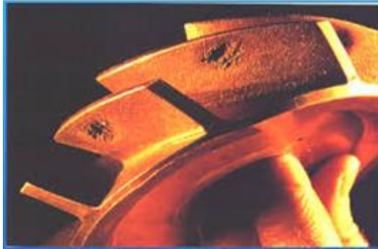
Ilustración 7. Corrosión por cavitación
