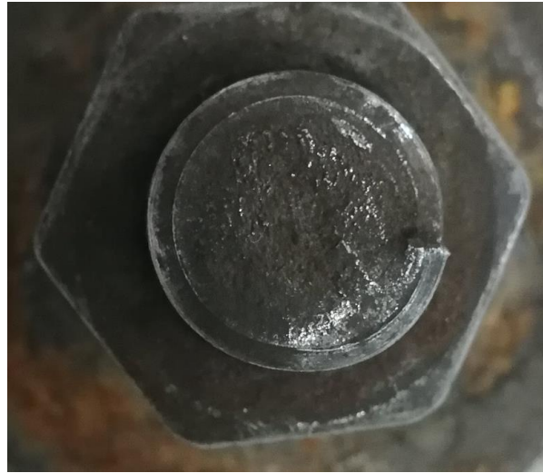
Ilustración 14. Detalle de la fractura del tornillo.
