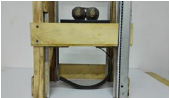
Fotografía 31 Flexión ballesta A 15 Kg
