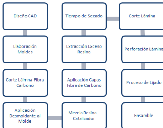
Figura 56 Procedimiento construcción tren de aterrizaje
