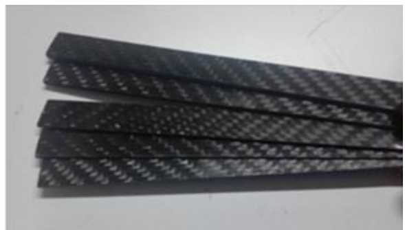
Fotografía 3 Aplicación de presión y corte de probetas
