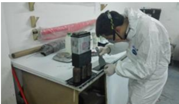
Fotografía 3 Aplicación de presión y corte de probetas
