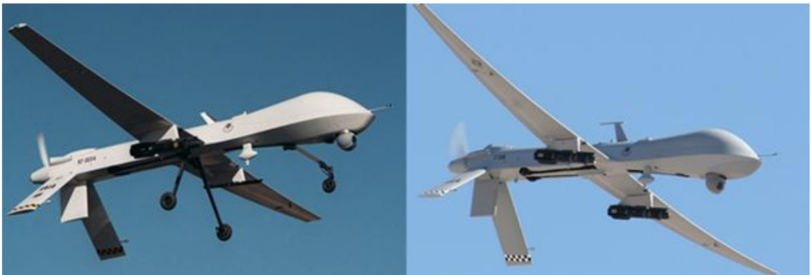
Figura 5 Tren retráctil en aeronave no tripulada
