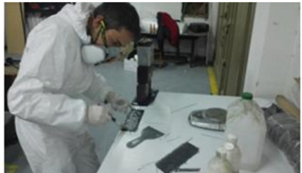
Fotografía 3 Aplicación de presión y corte de probetas
