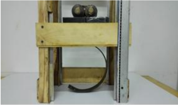
Fotografía 34 Flexión ballesta B 15 Kg
