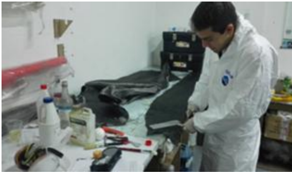
Fotografía 1 Corte de láminas de fibra de carbono
