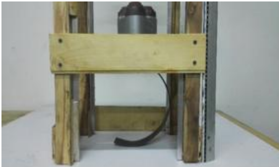
Fotografía 28 Flexión en ballesta C
