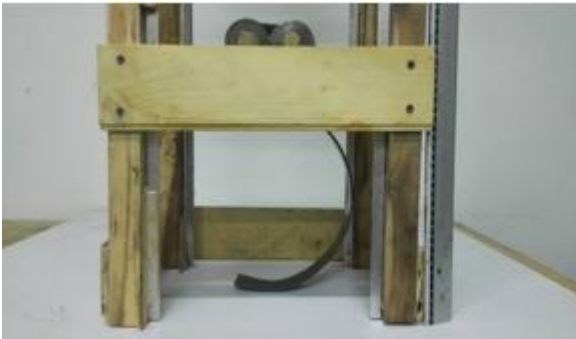
Fotografía 33 Flexión ballesta B 10 Kg
