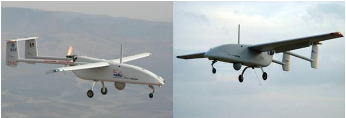
Figura 6 Tren fijo en aeronave no tripulada
