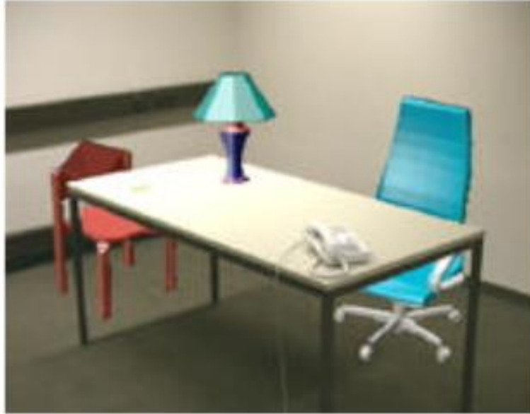
Kuva 2: Näkymään on lisättyä todellisuutta hyödyntämällä tuotettu kaksi tuolia ja lamppu. (Azuma, 1997. Alun perin: ECRC)
