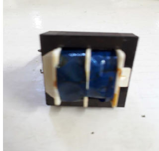
Figura 2-36. Transformador para la medición de voltaje. Fuente: Autor.
