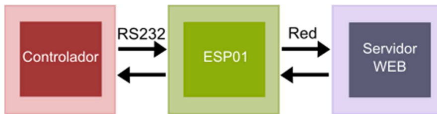
Figura 2-49. Comunicación controlador-servidor WEB. Fuente: Autor.
