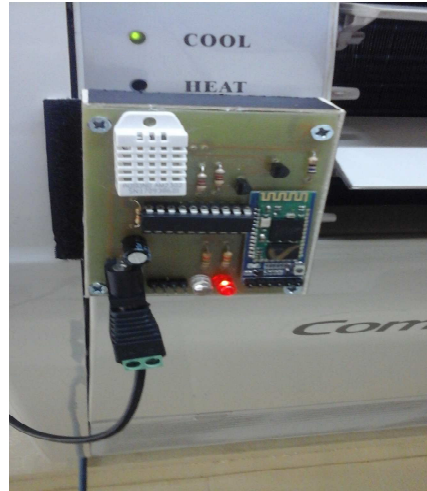
Figura 2-69. Montaje del controlador inteligente en el aire acondicionado del laboratorio de circuitos de FEC-UNI. (Vista B). Fuente: Autor.
