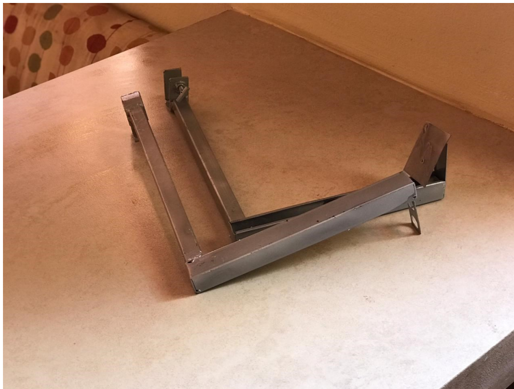
Figura 17 Brazos metálicos que contendrán el sensor de distancia
