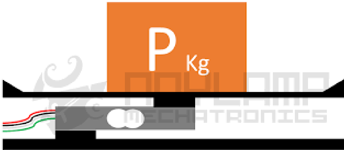
Figura 16 Celda de carga, en la cual sobre ella se coloca el peso.
