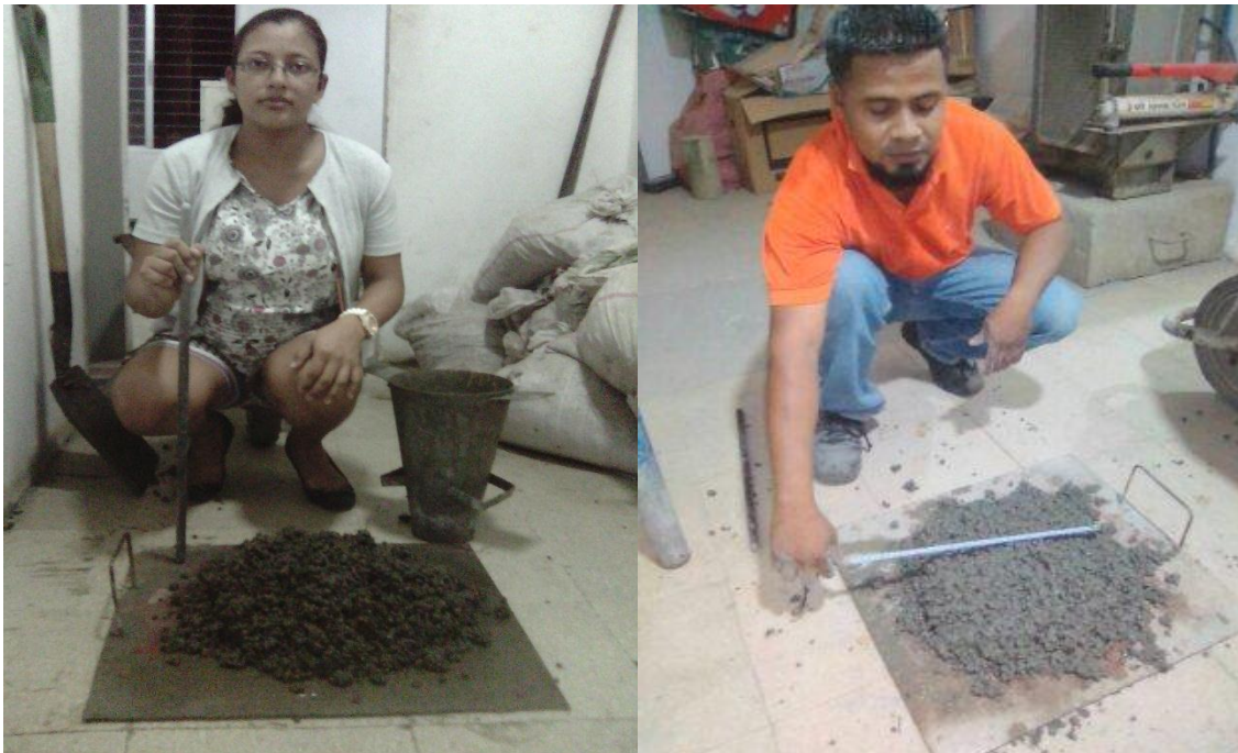
Figura 5.10 Ensayo del cono invertido en el concreto poroso
