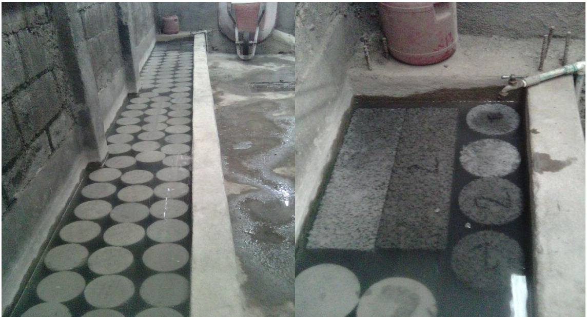
Figura 5.18 Muestra la pila y el curado del concreto permeable
