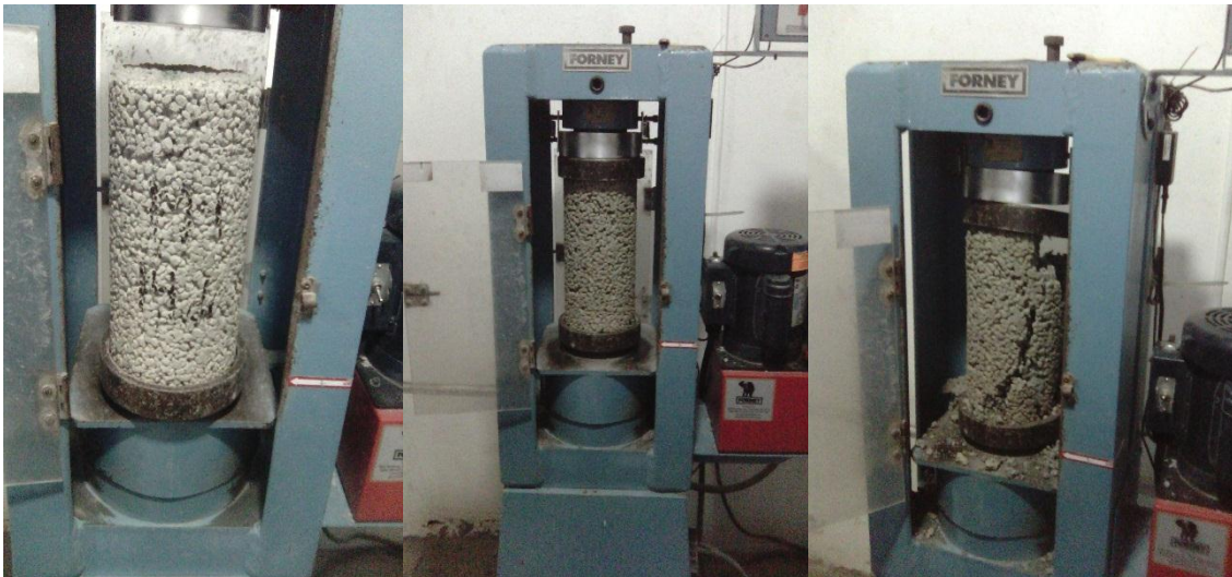
Figura 5.14 Muestra el ensayo a la compresión simple de un espécimen con capping (almohadillas de neopreno)
