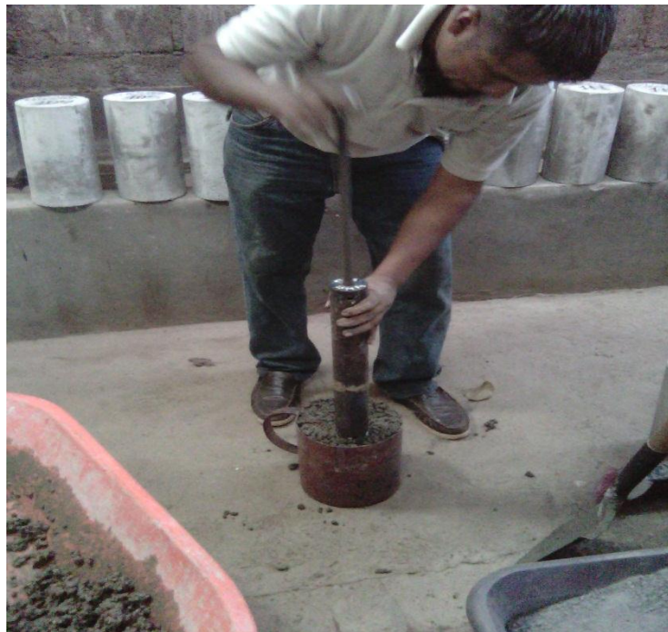
Figura 5.6 Compactación del agregado permeable
