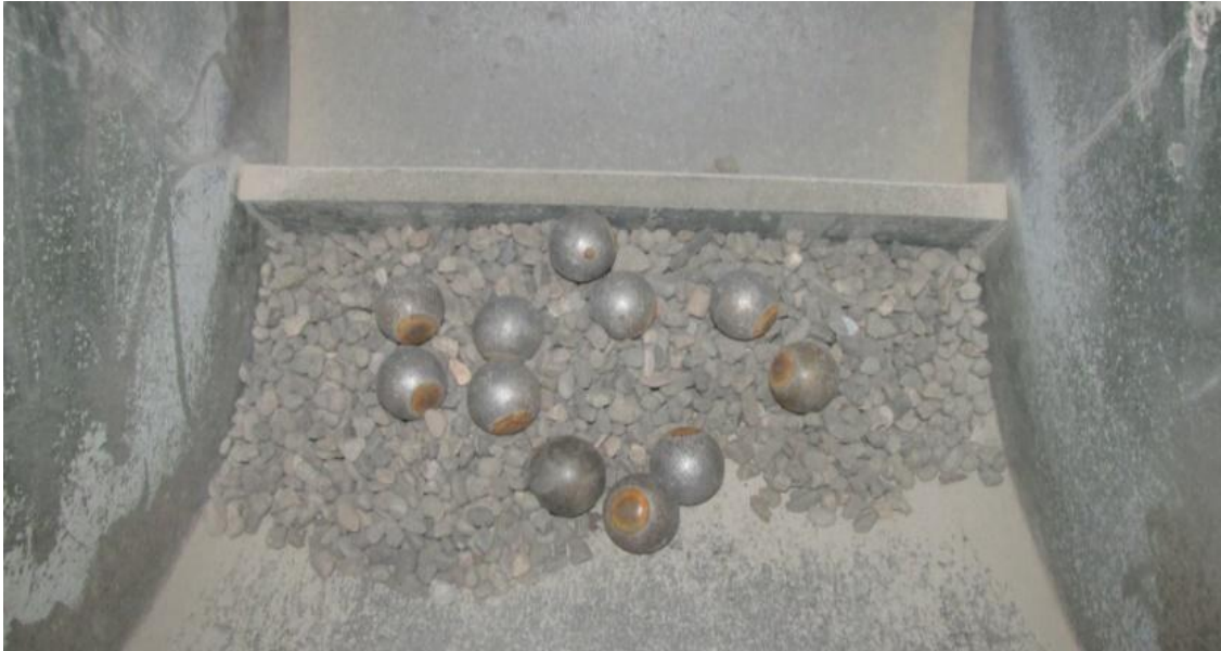
Figura 4.3 Muestra de agregado grueso introducido en la máquina de Los Ángeles
