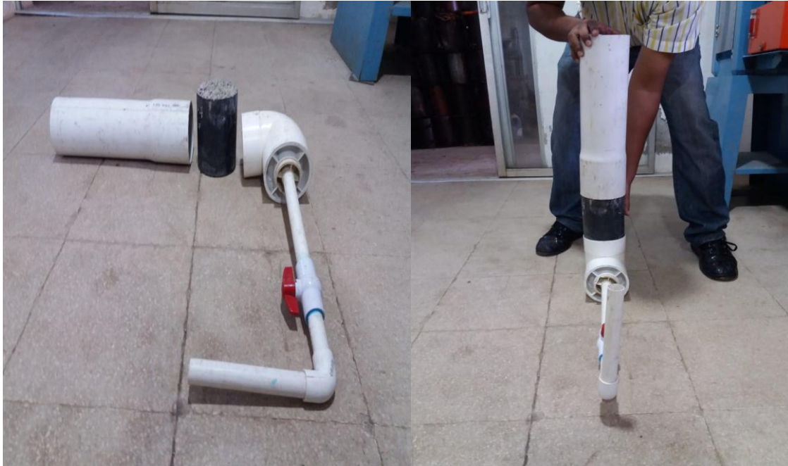
Figura 5.17 Equipos de ensayo de permeabilidad (equipo recomendado por el ACI 522R
