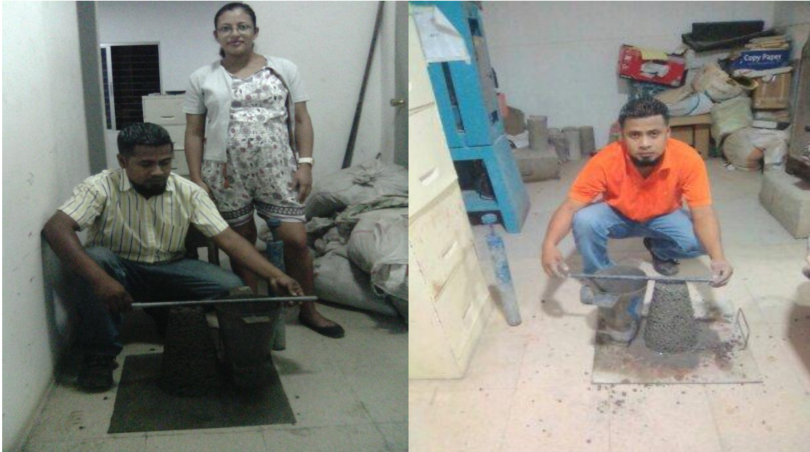
Figura 5.9 Procedimiento de ensayo de revenimiento o slump en el concreto permeable (asentamiento 0 cm)
