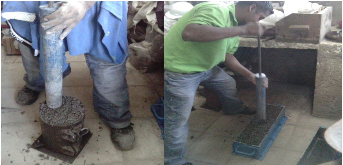
Figura 5.12 Muestra el compactado del concreto permeable
