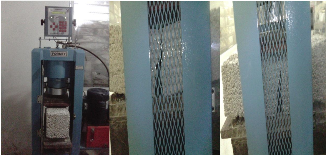
Figura 5.16 Ensayo para determinar la resistencia a la flexión
