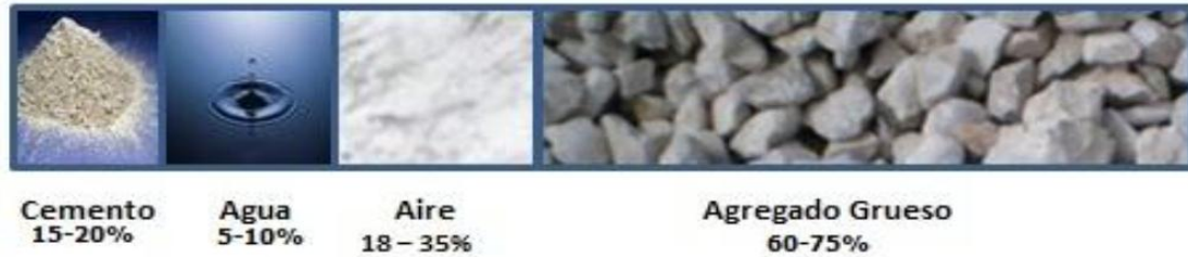
FIGURA 2.2- Variación de las proporciones usadas en concretos permeable, sin Agregado Fino.
