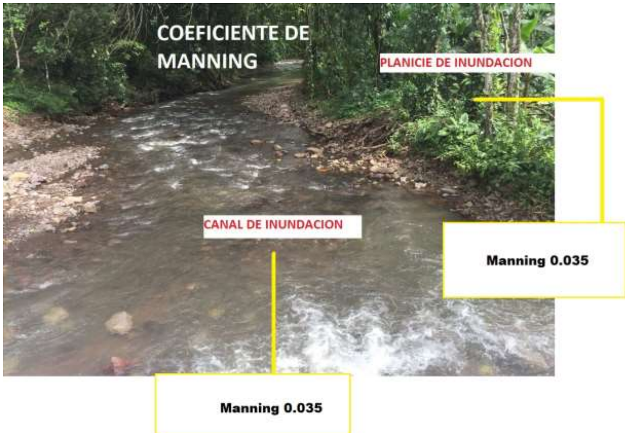
Figura 43: Fotografía del cauce y sus coeficientes de Manning
