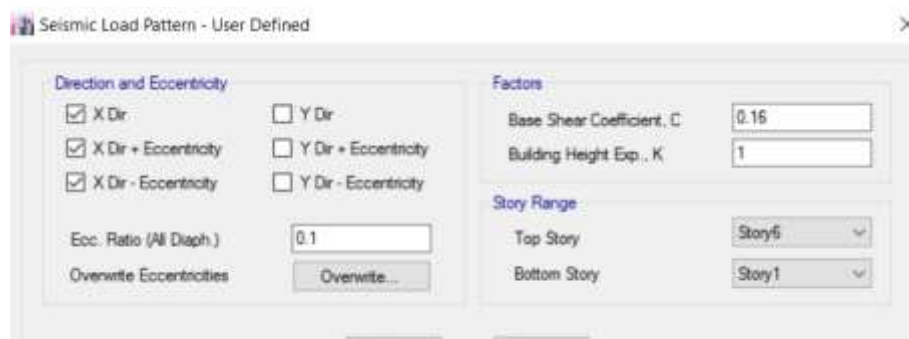
FIGURA 15 PATRON DE CASO SISMICO EN X
