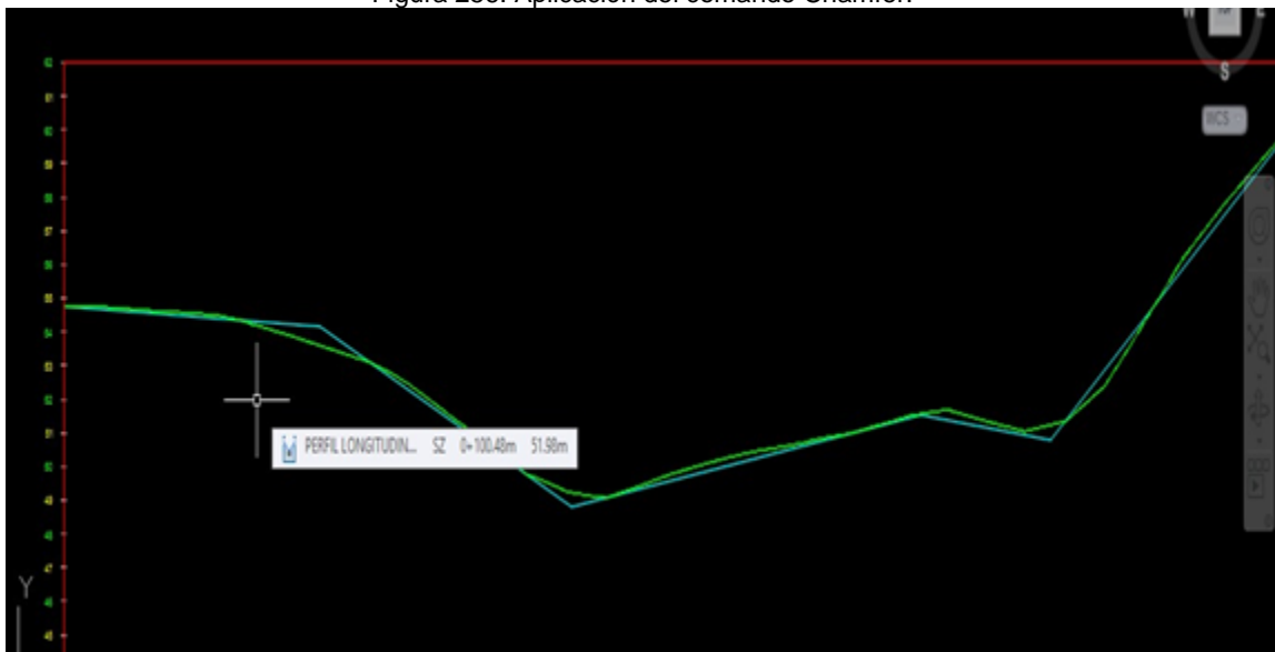
Figura 256. Aplicación del comando Chamfer.
