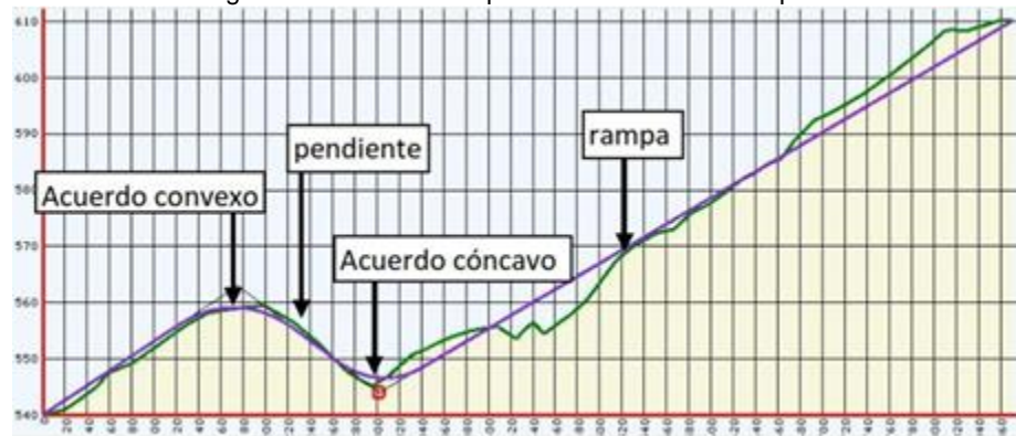
Figura 247. Elementos que forman el trazado en perfil.
