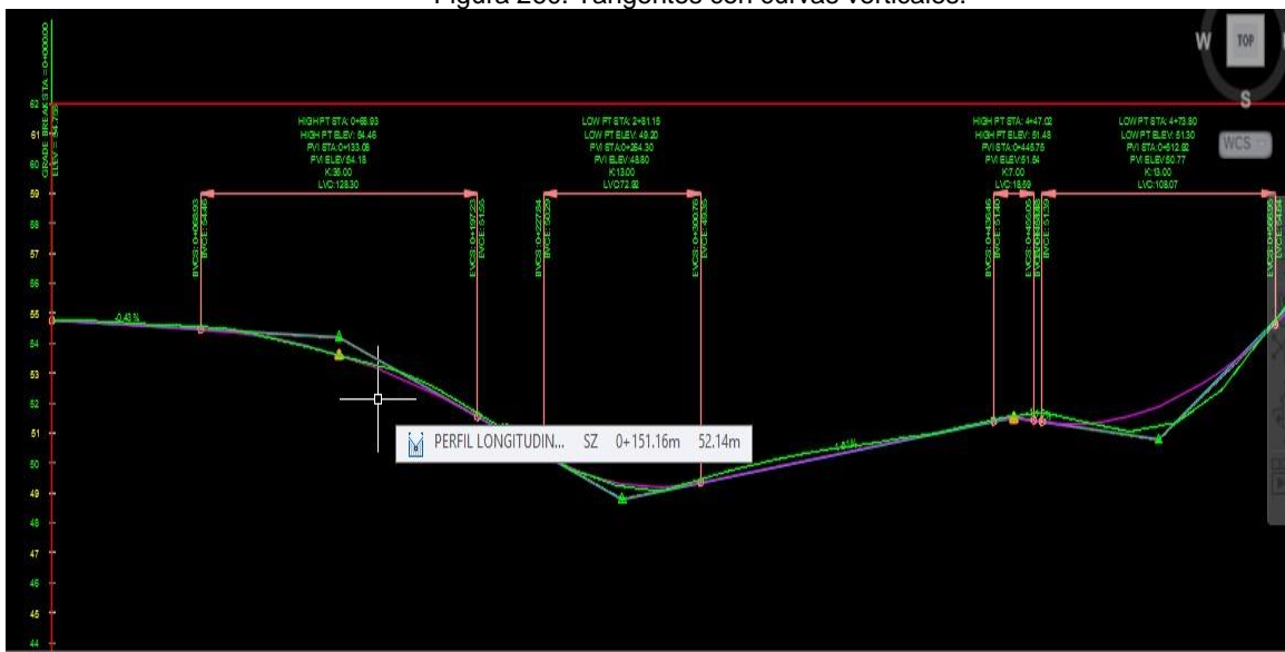
Figura 260. Tangentes con curvas verticales.
