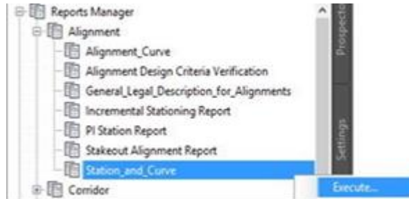
Figura 383. Generación del reporte del alineamiento horizontal.
