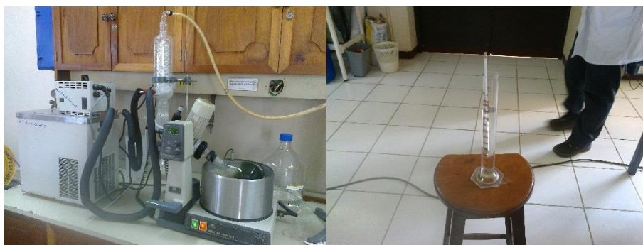
Figura 4. 13 Determinación del GAV del vino de Flor de Jamaica
