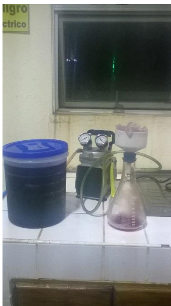
Figura 4. 6 Sistema de clarificación del vino de Flor de Jamaica
