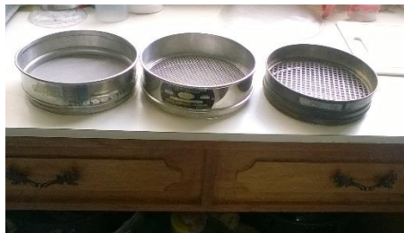
Figura 4. 1 Tamices utilizados para la selección y limpieza de la Flor de Jamaica
