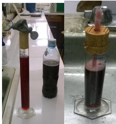
Figura 4. 25 Probeta antes y después del desplazamiento del vino por el dióxido de carbono
