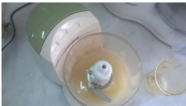
Fig. 5.1 Procesador de alimentos al momento de realizar la mezcla de la solución de hojuelas de quitosano + Acido + Aditivo .
