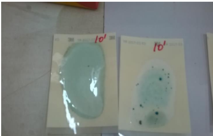
Fig. 5.6 Recuento Mohos y Levaduras a 25°C
